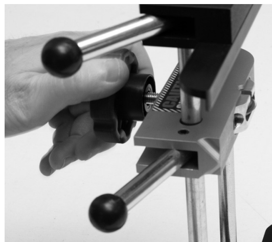
Étape 7 – Tourner le bouton dans le sens inverse des aiguilles d'une montre pour ramener la lame en position de rainage.
