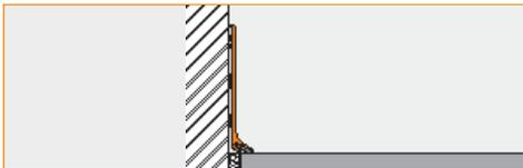
**16.2 Schluter®-DESIGNBASE-SL** est un profilé de finition pouvant remplacer les plinthes murales. Il est offert en aluminium anodisé, en aluminium coloré et en acier inoxydable. Il présente un fini épuré et se fixe simplement au mur à l'aide de l'adhésif approprié. En option, on peut y ajouter une lèvres d'étanchéité, qui aidera à protéger la transition sol-mur de l'humidité et atténuera les bruits d'impact.
