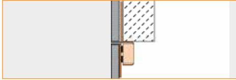
**11.1 Schluter®-REMA** est un système de trappe magnétique permettant un accès à l'intérieur des murs carrelés. Le système REMA comprend quatre plaquettes en aluminium aimantées amovibles rattachées chacune à un aimant et quatre contre-plaquettes ferromagnétiques. L'installation du REMA se fait indépendamment du format des carreaux et s'harmonise parfaitement au joint. De cette façon, les panneaux électriques ou la plomberie sont facilement accessibles sans modifier l'apparence du carrelage.
