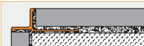
**2.12 Schluter®-INDEC** est un profilé d'aluminium anodisé de finition et de protection des rebords pour les coins extérieurs de surfaces carrelées. Il comporte une ailette d'ancrage perforée de trous en forme de trapèze qui s'enfonce dans le ciment-colle sous les carreaux, et sa surface apparente forme un angle droit intérieur décoratif. INDEC peut servir de profilé de transition ou d'arrêt pour un cadre de porte ou de fenêtre. Des coins extérieurs correspondants sont offerts.
