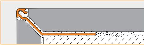
**Schluter®-FINEC-SQ** est un profilé de finition et de protection des rebords pour les coins extérieurs de revêtements carrelés ou de mosaïque. Il présente une surface visible symétrique de 3/16 po qui combine la finesse de FINEC et la forme carrée de QUADEC et est doté d'une ailette d'ancrage perforée qui s'enfonce dans le ciment-colle sous la céramique. Le profilé est offert en aluminium anodisé, en aluminium coloré et en aluminium coloré texturé.
