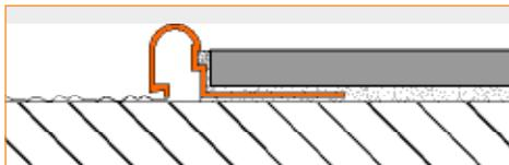
**2.5 Schluter®-RONDEC-DB** est un profilé décoratif en aluminium anodisé utilisé pour mettre en valeur les cimaises et plinthes. Il protège les surfaces carrelées contre les impacts mécaniques. Le profilé est muni d'une ailette d'ancrage perforée de trous en forme de trapèze qui s'enfonce dans le ciment-colle sous les carreaux. Sa forme arrondie, fortement saillante, établit une ligne définie le long des carreaux et permet de créer un design intéressant.
