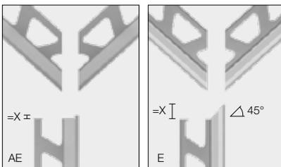
**Note :** Avec FINEC, coupez les carreaux adjacents au profilé à angle de 45°.
