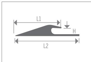
Réducteur à encart pour les installations de tapis collé. Languette souple jusqu'à 9,5 mm (3/8 po). Pour utilisation commerciale légère ou résidentielle.
