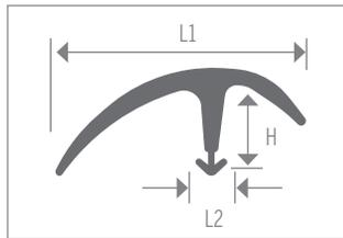
Capuchon en E et en T régulier à utiliser où les sols adjacents se rejoignent lorsque la coordination des couleurs est importante. Pour utilisation résidentielle ou en zone à circulation légère. Fait pour des écarts de hauteur inférieurs à 15,9 mm (5/8 po). Adapté aux canaux larges tels que CM1655, CM1755, CM1759, CM1140, CM14270, CM14271.
