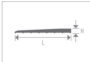
Bande de réduction pour installation contre un revêtement de sol en carreaux ou résilient. Offre une transition en douceur et sûre vers un support ou un revêtement de sol adjacent.
