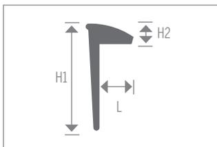
Peut être utilisé pour arrêter un tapis, un revêtement en céramique ou un panneau d'une épaisseur maximale de 6,4 mm (1/4 po).
