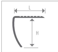
Nez de marche à recouvrement. Ce nez de marche en composite de caoutchouc et de vinyle dispose de grandes pattes permettant de recouvrir la zone endommagée ou les escaliers avec des hauteurs de marche particulièrement grandes.
