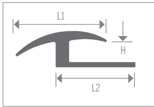
Réducteur de tapis à carreau à utiliser lorsqu'un tapis commercial rejoint un carreau. La languette souple permet une utilisation avec un tapis de 4,8 à 6,3 mm (3/16 à 1/4 po) rejoignant un carreau ou LVT de 2 à 3 mm (de 0,080 à 1/8 po).
