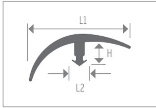
Capuchon en E et en T commercial à utiliser où les sols adjacents se rejoignent lorsque la coordination des couleurs est importante. Utiliser pour des écarts de hauteur inférieurs à 15,9 mm (5/8 po).
