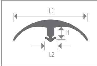
Capuchon en E et en T régulier à utiliser où les sols adjacents se rejoignent lorsque la coordination des couleurs est importante. Pour utilisation résidentielle ou en zone à circulation légère. Fait pour des écarts de hauteur jusqu'à 15,9 mm (5/8 po). Adapté aux canaux larges tels que CM1655, CM1755, CM1759, CM1140, CM14270, CM14271.
