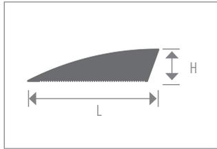
Ce réducteur aboutant est conçu pour les applications où il est nécessaire de réduire d'une hauteur de 10 mm (3/8 po) et de créer une transition uniforme à la surface du plancher adjacent.
