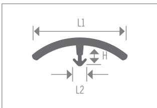
Capuchon en E et en T régulier à utiliser où les sols adjacents se rejoignent lorsque la coordination des couleurs est importante. Pour utilisation résidentielle ou en zone à circulation légère. Fait pour des écarts de hauteur jusqu'à 9,5 mm (3/8 po). Adapté aux canaux larges tels que CM1655, CM1755, CM1759, CM1140, CM14270, CM14271.
