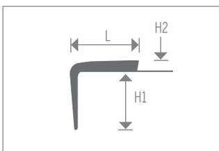
Nez de marche de type commercial à butée simple. Pour adosser à un carreau ou tapis jusqu'à 6 mm (1/4 po) d'épaisseur.
