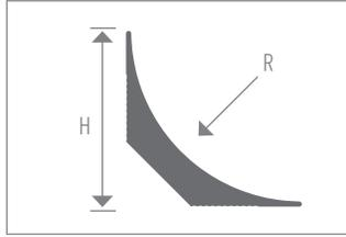
Finition de plinthe flexible. Utilisé avec un tapis ou un revêtement de sol résilient afin de soutenir la zone d'angle du matériau de revêtement.
