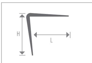
Baguette à angle en vinyle souple : Protecteur d'angle pour les murs et entrées de porte lorsqu'un butoir est nécessaire. Ce produit ne rétrécira pas, ne se fêlera pas et ne s'écaillera pas comme les plastiques rigides.
