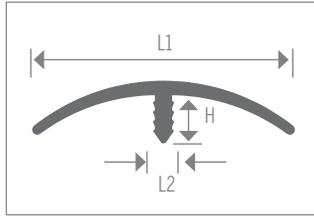
Capuchon en E et en T commercial à utiliser où les sols adjacents se rejoignent lorsque la coordination des couleurs est importante. Capuchon en E et en T pour une utilisation où les écarts de hauteur sont inférieurs à 15,8 mm (5/8 po). Conçu pour les utilisations commerciales à forte circulation. Utiliser avec CM2678, CM1659, CM1751 et CM1752.
