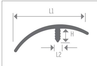
Capuchon en E et en T commercial à utiliser où les sols adjacents se rejoignent lorsque la coordination des couleurs est importante. Capuchon en E et en T pour une utilisation où les écarts de hauteur sont inférieurs à 15,8 mm (5/8 po). Conçu pour les utilisations commerciales à forte circulation. Utiliser avec CM2678, CM1659, CM1751 et CM1752.
