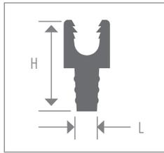
Prolongement de canal. Fabriqué en PVC rigide. Utiliser sur les installations de carreaux en céramique avec insertion dans le rail. Ce prolongement augmente la hauteur actuelle du canal de 9,5 mm (3/8 po).
