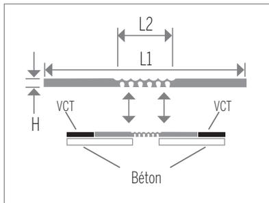
Le couvre-joint d'expansion pour sol résilient empêche les fissures dans le revêtement de sol provoquées par la dilatation et la contraction du béton. La section nervurée de la finition est alignée sur la coupure de scie dans la dalle qui bute contre le revêtement de sol. Utiliser avec un revêtement de sol en VCT, vinyle solide, caoutchouc, linoléum ou LVT.
