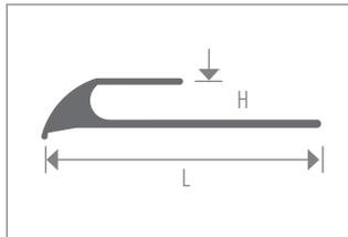
Réducteur à encart pour les installations de tapis collé. Languette souple jusqu'à 8 mm (5/16 po). Également disponible avec dos autocollant.
