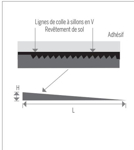
Égalisateur de sol (bande de réduction en vinyle) avec technologie des sillons en V. Crée une transition entre les sols jusqu'à 1,3 cm (1/2 po). Solution économique pour les variations de hauteur, égalise rapidement les niveaux des sols. Économise du temps et de la main d'œuvre. Tailles de longueur sur mesure disponibles. Collé, cloué et agrafé directement au support. Le revêtement de sol peut adhérer directement dessus.
