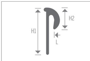
Arrêt d'angle résilient de 3,2 mm (1/8 po) à utiliser pour couvrir un tapis d'une épaisseur maximale de 4,8 mm (3/16 po). Bande adhésive pour application facile.
