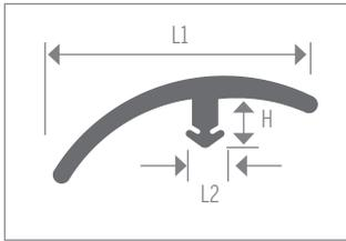
Capuchon en E et en T régulier à utiliser où les sols adjacents se rejoignent lorsque la coordination des couleurs est importante. Pour utilisation résidentielle ou en zone à circulation légère. Fait pour des écarts de hauteur jusqu'à 15,9 mm (5/8 po). Adapté aux canaux larges tels que CM1655, CM1755, CM1759, CM1140, CM14270, CM14271.
