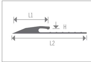
Réducteur à encart pour les installations de tapis collé. Peut être utilisé avec des tapis jusqu'à 1,13 kg (40 oz). Languette souple jusqu'à 9,5 mm (3/8 po). Pour utilisation commerciale intense. Disponible également avec patte RD2140 de 3 mm (1/8 po). Sur commande.
