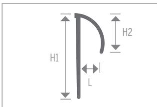
Arrêt d'angle de 6 mm (1/4 po) à utiliser pour couvrir un tapis d'une épaisseur maximale de 7,9 mm (5/16 po).
