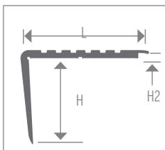
Conçu pour créer une installation des planchers en VCT, LVT et LVP « par le dessus » lorsqu'il est installé sur des marches. Possède une conception, en attente de brevet, en queue d'aronde « verrouillable et collée » en dessous et une encoche d'allègement sous le nez de marche. Ces nouvelles caractéristiques fournissent une adhésion supérieure et simplifient l'installation.
