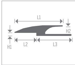
Réducteur de tapis à carreau. Crée une transition attrayante et sûre entre un tapis et un sol de 3 mm (1/8 po). Les bords des deux revêtements de sols peuvent facilement être bordés afin de les protéger des dommages. La languette inférieure est conçue pour permettre au tapis et à la moulture d'être collés ensemble et fixés au sol.
