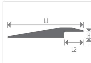
Réducteur de chevauchement de carreaux pour utilisation avec revêtement de sol résilient ou LVT de 2 à 3 mm (0,080 à 0,125 po) d'épaisseur.
