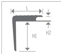
Conçu pour les installations de tapis ou de carreaux de tapis par insertion, lorsqu'il est installé sur les marches. La lèvre flexible recouvre le bord coupé du tapis. Possède une conception, en attente de brevet, en queue d'aronde « verrouillable et collée » en dessous et une encoche d'allègement sous le nez de marche. Ces nouvelles caractéristiques fournissent une adhésion supérieure et simplifient l'installation.
