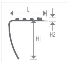
Nez de marche avec chevauchement tombant. Utiliser pour adosser à un sol en carreaux LVT ou résilient jusqu'à 3 mm (1/8 po) d'épaisseur. Protège le rebord du revêtement de sol contre les dommages sur la surface de la marche et offre davantage de traction pour la sécurité.
