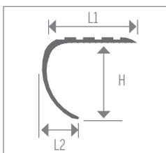
Nez de marche arrondi conçu pour être utilisé sur les marches à nez arrondi. Le nez arrondi souple permet une installation facile. Le retour de 15,9 mm (5/8 po) permet de dissimuler la face inférieure de la marche.
