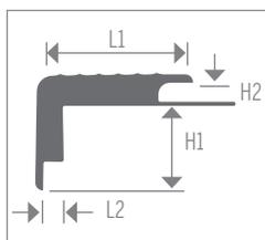
Nez de marche commercial à double friction. Pour tapis ou carreaux jusqu'à 9,5 mm (3/8 po) d'épaisseur. Cranté pour une installation facile.
