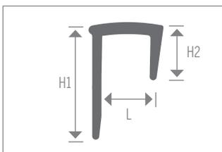
Arrêt carré d'angle à utiliser pour couvrir un tapis d'une épaisseur maximale de 7,9 mm (5/16 po) et lorsqu'un aspect carré est requis. Disponible avec bande adhésive ou à endos régulier.
