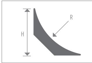
Finition de plinthe rigide. Utilisé avec un tapis ou un revêtement de sol résilient afin de soutenir la zone d'angle du matériau de revêtement. Marquer et casser net à la bonne dimension pour une installation facile.
