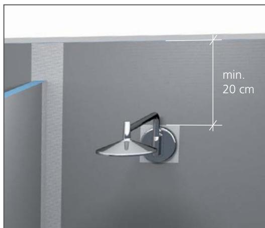
Illustration 3 : Étanchéité murale 20 cm minimum au-dessus du point d'eau
