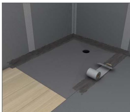
Illustration 14 : Étanchéité de panneaux de construction wedi et receveur Fundo contiguë au ou intégrée dans le support en bois
