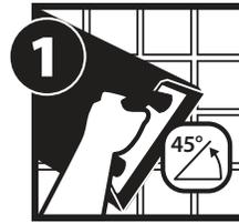
Apply grout diagonally into joints with rigid float at a 45° angle. Ensure grout is well compacted into joint cavities, leaving no voids or air pockets. Enfoncer le coulis en diagonale dans les joints à l'aide de la taloche rigide maintenue à un angle de 45°. S'assurer de bien compacter le coulis dans les joints pour éviter la formation de vides et de trous d'épingle.
