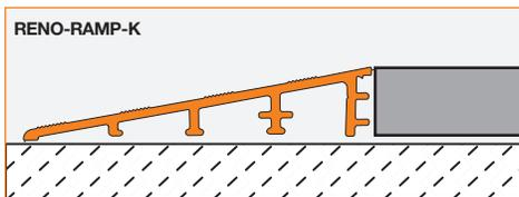
**1.8 Le Schluter®-RENO-RAMP** procure une transition douce entre le revêtement de carreaux de céramique et le revêtement de plancher adjacent qui se situe plus bas, tel que le béton sec. Ce profilé s'utilise particulièrement dans des applications commerciales où des charriots sont
