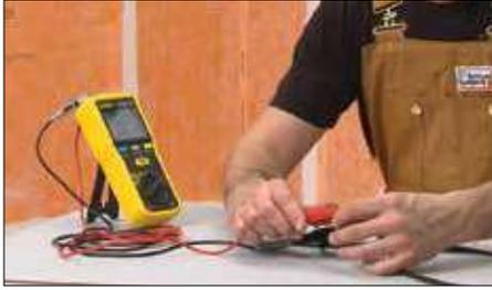
**1** Avant de tirer le câble chauffant hors de la bobine, effectuez le premier test et consignez-en le résultat dans le registre de test du câble chauffant, à la page 37. Si un bris ou un dommage est décelé au moment des tests, retournez le câble au point d'achat d'origine.
