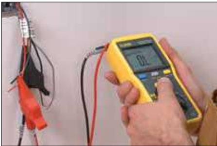
**4** Une fois la pose des câbles chauffants et des capteurs thermiques au sol effectuée, reprenez les tests et consignez leurs résultats dans le registre de test de câble chauffant (page 37).
