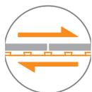
La membrane DITRA offre une désolidarisation (souplesse géométrique) grâce à ses nervures entrecroisées, qui permettent les mouvements de cisaillement horizontaux, ce qui neutralise efficacement les contraintes de mouvement différentiel entre le substrat et le carrelage.
