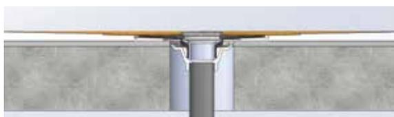
**Remarque :** Schluter®-Systems recommande fortement de réaliser, dans la mesure du possible, un contrôle d'étanchéité du raccordement entre le drain et la conduite d'évacuation avant de poursuivre l'installation. Veuillez consulter le code de plomberie local pour connaître toute exigence particulière s'appliquant dans votre secteur.
