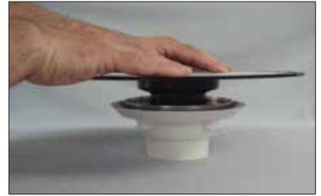
**3** Insérez la bride dans l'anneau de l'adaptateur, en vous assurant de son soutien adéquat par du mortier ou par la section centrale de la base de douche en polystyrène. Selon la hauteur du drain en place, il pourra être nécessaire de poser KERDI-BOARD, un panneau à carreler, un panneau de gypse résistant à l'eau ou un produit similaire avant la base pour arriver à la hauteur désirée. Posez la base selon les instructions présentées à la page 24.
