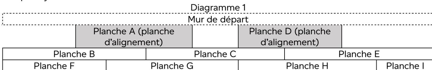
4. Prenez une autre planche complète (**Planche C** dans le diagramme 1) et orientez sa languette vers la rainure exposée du côté long de la **Planche A**. Ne l'abaissez pas tout de suite! Tandis que la languette de la **Planche C** est enclenchée dans la rainure de la **Planche A**, faites glisser la **Planche C** jusqu'à ce que son côté court entre en contact avec le côté court de la **Planche B**.
