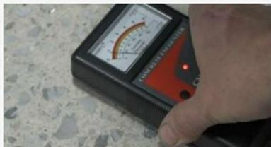
Effectuer un test du niveau d'humidité à l'aide d'un humidimètre ou d'une pellicule de plastique.
