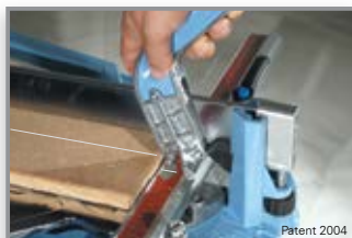
Ammortizzatore finecorsa per un lavoro silenzioso Shock-absorber for silent work
