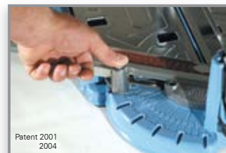
Tasto regolabile, per il posizionamento rapido della barra metrica alle angolazioni più usate Adjustable stop for quick positioning of metric bar to the angles most commonly used
