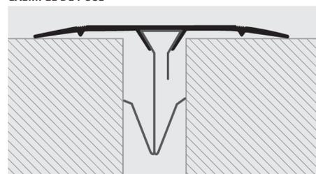
Les **PROPLATE FIX** sont une série de profilés couvre-joint plat permettant de couvrir les mouvement structuraux et de dilatation (retrait flexion-retrait compression) de deux structures portantes différentes.
