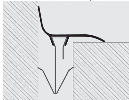
1. Choisir le profilé de la largeur et du matériel désirés. 2. Introduire tous les 50/75 cm (5 pièces pour un usage vertical - 10 pièces pour un usage horizontal) les clips de fixation dans la rainure prévue à cet effet. 3. Introduire le PROPLATE FIX, à la main en pressant de manière uniforme ou à l'aide d'un marteau en plastique, dans le vide existant de manière à créer un couvre-joint parfait. Suivre la même méthode pour la pose en angle.
