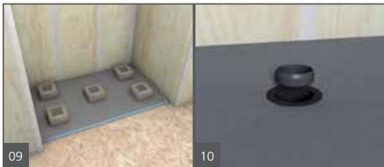
Enfoncer fermement le Fundo dans le lit de ciment-colle, en vérifiant que l'installation soit de niveau et exempte de vide. Répartir et laisser des poids sur la surface, puis drainer la zone pour permettre au ciment-colle de prendre initialement sans être dérangé (par exemple, poser des sacs de ciment-colle).
