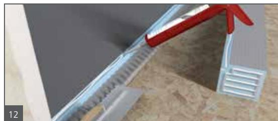
Les niches wedi sont installées dans une découpe pratiquée dans le mur wedi et fixées directement par leurs brides au milieu des montants espacés de 406,4 mm (16 po) centre à centre. Du produit d'étanchéité wedi est déposé le long du contact entre le mur et la niche.
