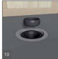
Installer le joint d'étanchéité en caoutchouc (côté biseauté au-dessus) autour du tuyau de 50,8 mm (2 po) dans le sous-plancher. Le joint en caoutchouc doit être à fleur de l'extrémité supérieure du tuyau de 50,8 mm (2 po) en ABS ou en PVC.
