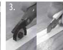
3. Cut tape with roller knife or straight blade knife. Coupez le ruban masquant à l'aide d'un couteau multiple usage à lame fine. Corte la cinta adhesiva con una navaja de rodillo o con una navaja de cuchilla.
