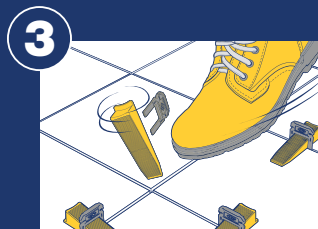
3 Remove after drying Retirez-la après le séchage Remuévalo después de haberse secado
