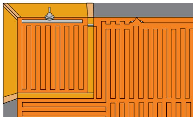
Les câbles peuvent être espacés à 3 crampons ou à un alternance de 3 crampons - 2 crampons séquence, en fonction de la puissance de sortie. Veuillez consulter le manuel d'installation DITRA-HEAT pour en savoir plus.
