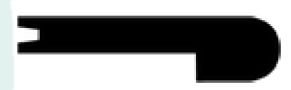
Nez de palier montage encastré Coordonnées 2336 mm x 18 mm x 79 mm (92" x 0,709" x 3,110")
