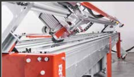
**SCIÉS À EAU AVEC MOTEUR COULISSANT AVEC AVANCEMENT AUTOMATIQUE (DISQUE SIMPLE)**
