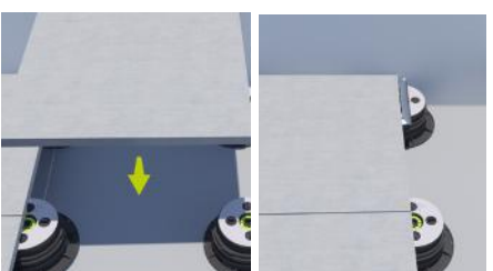
7. Die Fliesen verlegen.
