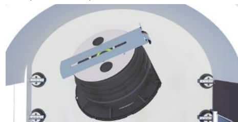
7. Placer la cale SUPACLPP perpendiculairement au mur.
