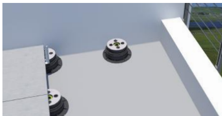
2. Posizionare il supporto con il lato tagliato a contatto con la parete.
