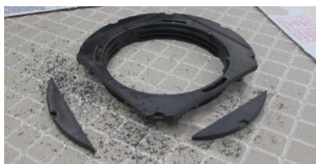
1. Das Basisteil umdrehen und an zwei Seiten entlang der Perforierung abschneiden.
