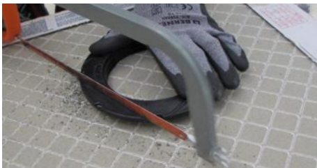
8. Die Basis umdrehen und eine der Seiten entlang der vorgeprägten Linie entfernen.
