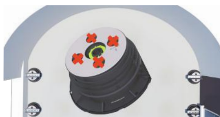
6. Retirar todas las aletas del cabezal.
