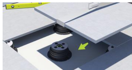
5. Mettre le carrelage en place.
