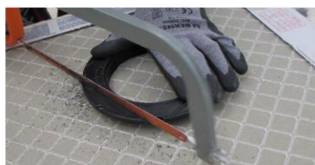
7. Tournez la base et coupez un des côtés le long de la ligne pré-coupée.
