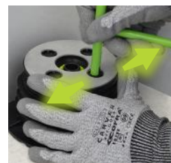
3. Coupez les ailettes avec la clé SUPAK.
