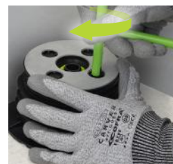
3. Rimuovere le quattro alette con la chiave SUPAK.
