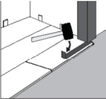
Étape 2 : Utiliser un marteau et une barre de traction pour bien bloquer l'extrémité courte de la planche.
