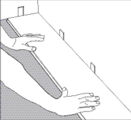
Étape 1 : Commencer l'installation en travaillant de gauche à droite. Insérer des cales d'espacement aux extrémités et sur les bords là où les planches rejoignent un mur.
