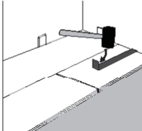
Étape 8 : Utiliser un marteau et une barre de traction pour bien bloquer la dernière pièce de la rangée. Insérer une cale d'espacement à la fin de la rangée. Poursuivre l'installation jusqu'à la dernière rangée.
