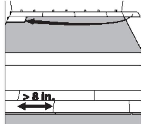
Étape 3 : Utiliser le reste de planche de la première rangée pour entreprendre la deuxième rangée. Il doit y avoir au moins 8 po entre les joints d'extrémité des planches sur les rangées adjacentes [8 po]
