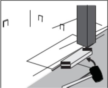
Étape 1 : Réduire l'espace sous le montant de porte de façon à ce que la planche puisse y être glissée librement. Tapoter aussi le bord long avec un marteau et une cale de frappe.
