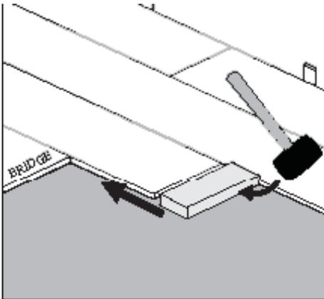
Étape 7 : Tapoter l'extrémité de la planche avec un marteau et une cale de frappe afin de bien bloquer les extrémités des planches l'une dans l'autre. Enlever la pièce de rapprochement et poursuivre vers le mur jusqu'à l'installation de la dernière planche de la rangée. S'ASSURER DE TAPOTER SUR LE BORD DU VINYLE DE FAÇON À NE PAS ENDOMMAGER LE PROFIL DE BLOCAGE.
