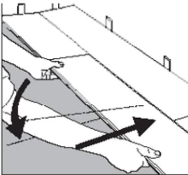
Étape 4 : Bloquer le rebord long de la planche en insérant la languette dans la rainure en angle et en laissant tomber la planche en place. Glisser la planche vers l'extrémité de la planche installée précédemment jusqu'à ce que la languette effleure la rainure.
