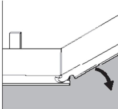
Étape 2 : Bloquer l'extrémité courte de la planche en insérant la languette dans la rainure en angle et en laissant tomber la planche en place. Continuer jusqu'au bout de la première rangée.
