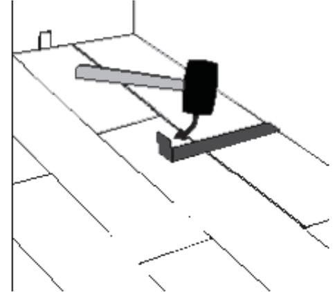
Étape 9 : Utiliser un marteau et une barre de traction pour bien bloquer les bords longs des planches sur la dernière rangée.
