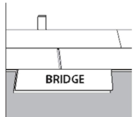
Étape 6 : Fixer une retaille de plancher pour empêcher deux planches de glisser latéralement lors du rapprochement de l'espace laissé entre les extrémités de celles-ci. [PIÈCE DE RAPPROCHEMENT]
