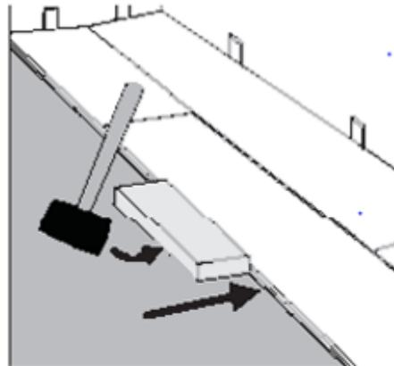
Étape 5 : Utiliser un marteau et une cale de frappe pour tapoter le bord long de la planche afin d'assurer un ajustement serré. TOUT ESPACE ENTRE LES PLANCHES PEUT COMPROMETTRE LE SYSTÈME DE BLOCAGE.
