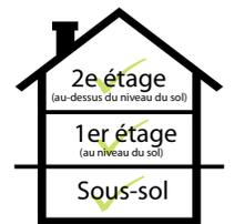
Lors de l'installation sous le niveau ou sur le béton, une barrière de vapeur poly 6 mil doit être utilisée
