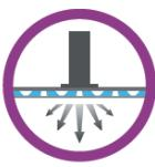
La conception brevetée de la membrane FLEXDECO permet de transmettre uniformément la charge du revêtement de sol au sousplancher. Chaque crampon Carré arrondi possède une cavité centrale de la forme d'une pyramide inversée. Lorsqu'elle est remplie de ciment-colle, cette pyramide inversée devient une structure incompressible. Ces cavités agissent comme des piliers dans la structure de soutien.
