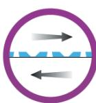
La membrane FLEXDECO neutralise les mouvements longitudinaux entre le sous-plancher et les carreaux afin d'empêcher la fissuration des carreaux; il est ainsi possible d'installer un système de plancher chauffant même sur des supports problématiques tels que le bois et les supports fissurés mais stables.
