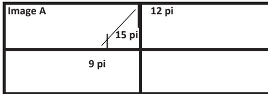
Pour vous assurer que vos lignes sont perpendiculaires, mesurez 12 pi à partir du point central vers le haut et faites une marque. Dans le même quadrant, mesurez 9 pi horizontalement. Si vos lignes sont perpendiculaires, la diagonale entre les deux marques devrait mesurer exactement 15 pi. Si ce n'est pas le cas, apportez les corrections nécessaires (consultez l'image A).
