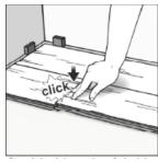
Étape 4 : Fixez les extrémités longues des planches en insérant la languette dans la rainure en angle et en appuyant jusqu'à l'emboîtement. Glissez la planche vers l'extrémité de la dernière planche installée jusqu'à ce que la languette touche légèrement la rainure.
