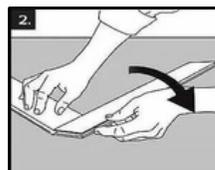
pour bien verrouiller les panneaux ensemble. Vérifier que les rainures des deux panneaux forment une ligne continue.
