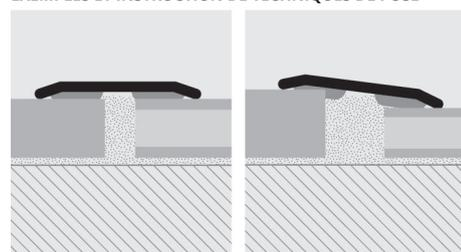
1. Choisir la finition de surface du PROCOVER 14PT et le couper à la longueur nécessaire. 2. Dégraisser, laver et bien nettoyer le plan solide. 3. Enlever le papier de protection de l'autocollant. 4. Placer le profil en exerçant une pression uniforme sans marteler.
