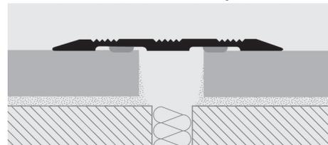
1. Choisir la version avec ou sans autocollant du PROPLATE 80ALZ, le couper à la longueur nécessaire. 2. Dégraisser, laver et bien nettoyer le plan solide. 3a. Enlever le papier de protection de l'autocollant (version autocollante). 4a. Placer le profil en exerçant une pression uniforme sans marteler. 3b. Réaliser des trous sur un côté et insérer les chevilles dedans. 4b. Fixer le profil à l'aide de vis à tête évasée conformes aux emplacements des trous effectués.
