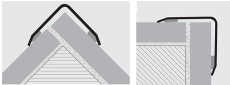
1. Choisir le profilé nécessaire pour couvrir l'angle du revêtement/mur. 2. Nettoyer la surface d'appui et s'assurer qu'elle ne soit ni grasse ni humide. Une température supérieure à 15° est conseillée pour l'application. 3. Enlever le film de protection et/ou thermo packed puis le papier de l'adhésif avant de poser délicatement le profilé, sans marteler, en pressant de manière uniforme.
